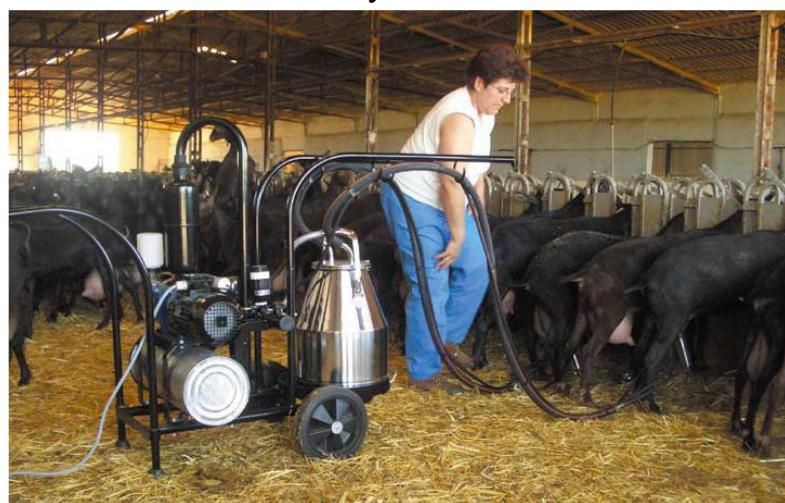
1-расм. ММУ SG соғиши ускунасининг умумий кўриниши
